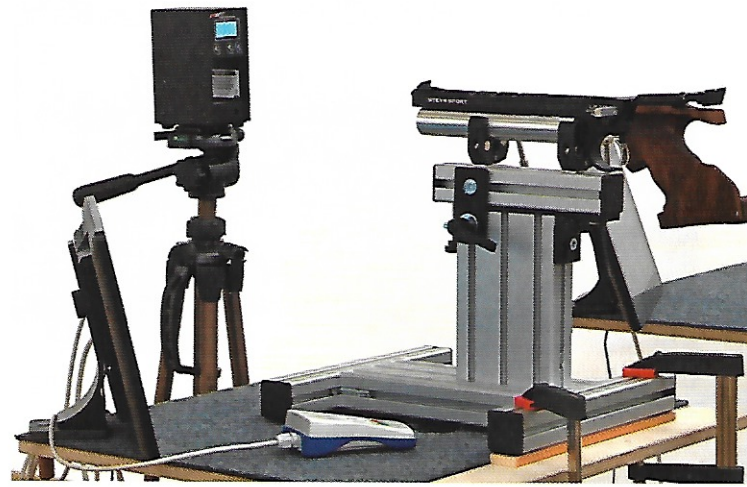
Die Geschwindigkeitsmessung erfolgte nach akkuratem Aufbau.
